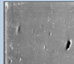
Biofilm nakon kontinuiranog tretmana sa 0,3 mg / l slobodnog hlora (ECA)
